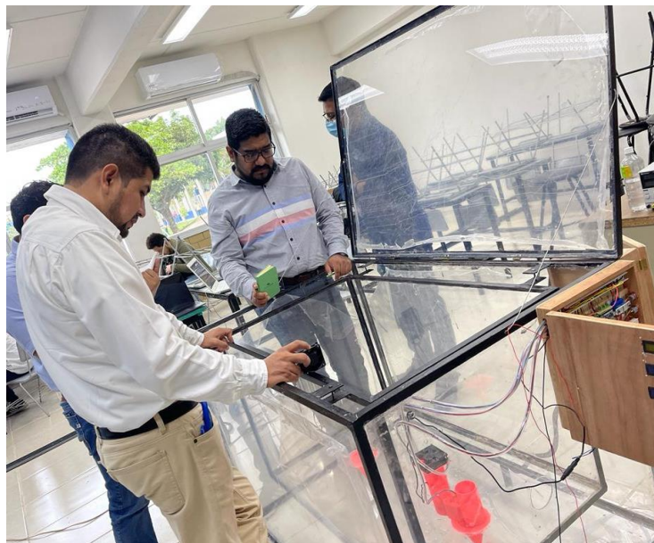
Cámara de niebla construida
